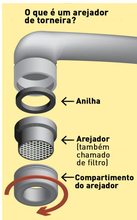
É um dispositivo que está fixo à ponta da torneira. Este permite poupar água, filtra quaisquer resíduos e impede que a água salpique.
